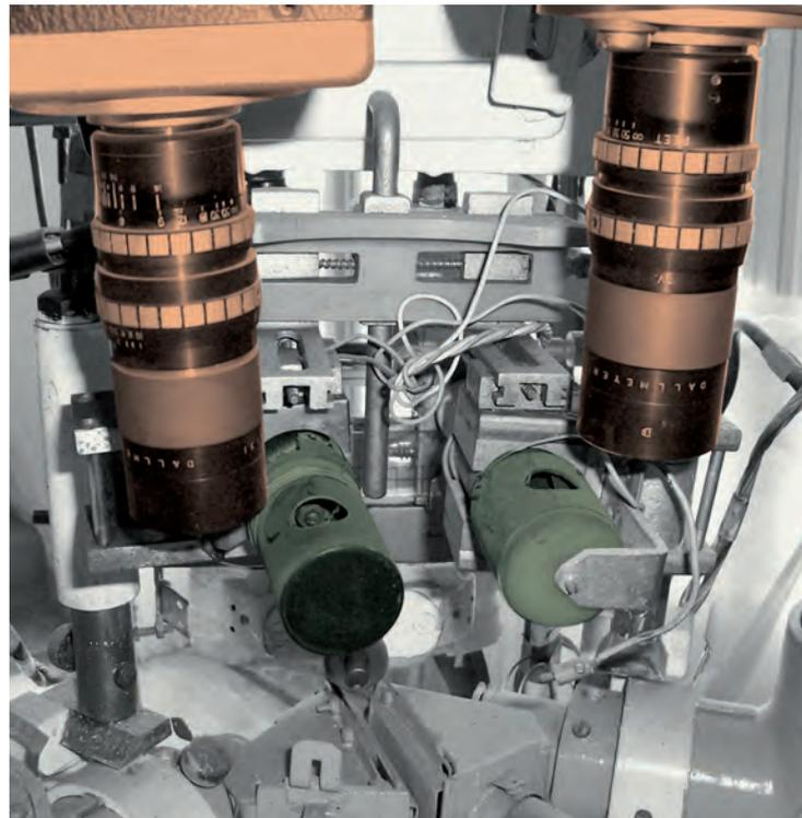
Detalles de los tubos de separación. En esta foto se pueden ver con más detalle los dos cilindros con las perforaciones para la separación de las imágenes
